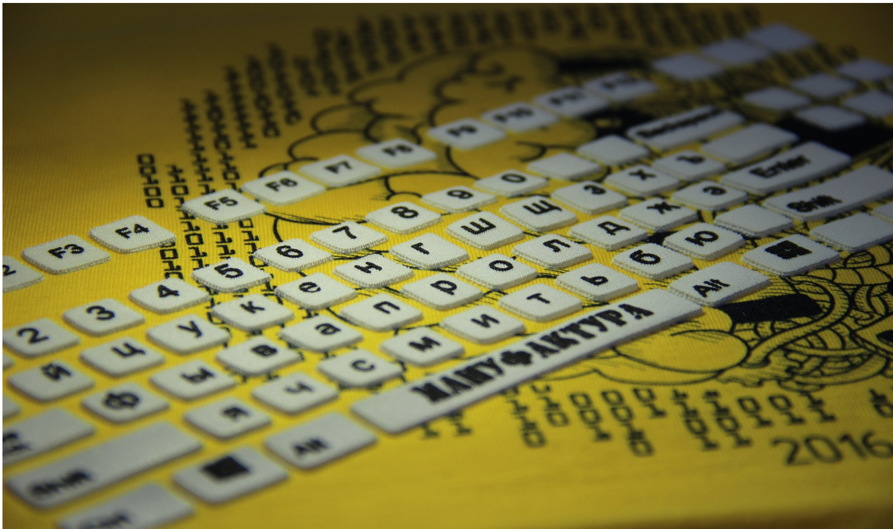
Шелкография пластизолевыми красками с 3D подъемом.
